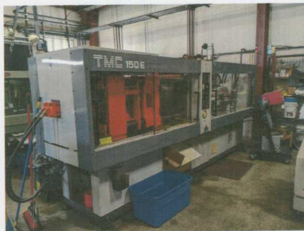
20. ábra: TMC típusú fröccsöntőgép (csak példa)
