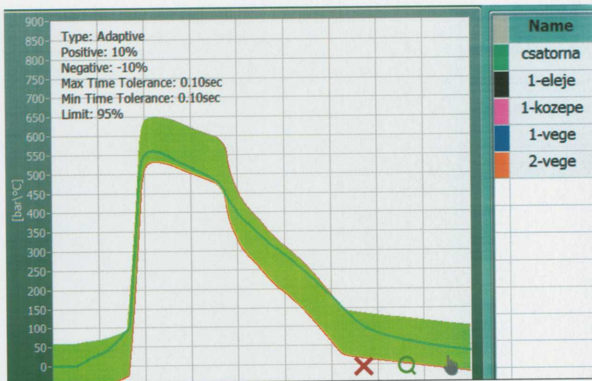
12.Ábra: Fröccsöntési ciklus közben felvett nyomás görbe a beömlőcsatorna közelénél mérve
